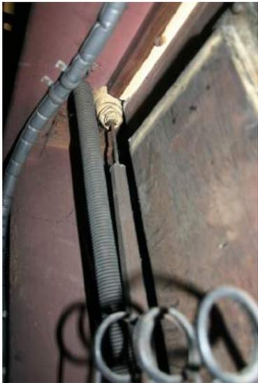
Le mécanisme d'appel d'anches est constitué par cette tige reliée à une barre en chêne et entrant dans le porte-vent grâce à cette jonction de peau que l'on voit sur la photo de gauche.
