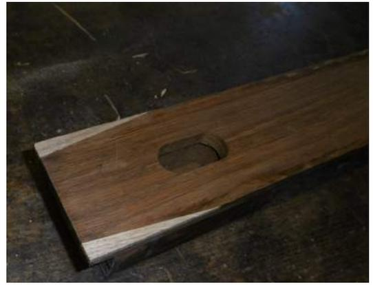
Pour éviter que ce problèmes ne se repose à l'avenir, il a été décidé avec l'AMO de modifier le système de fixation de ces soufflets. Les trous importants laissés par le brûlage des vis dans les tables ont été bouchés par des inclusions de chêne avant la remise en peau des soufflets.
