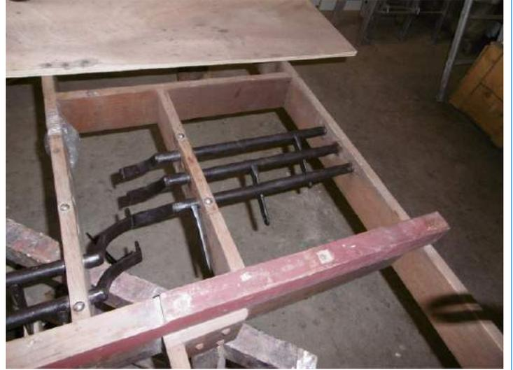
Les liaisons de la mécanique des jeux ont toutes été restaurées de la manière suivante : après nettoyage des structures et des rouleaux à l'éponge bouillante serrée, remise en peinture au noir de ferronnerie (action anti-rouille) des pièces en acier, y compris les rouleaux d'abrégé de note.
